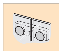
Z vnitřní strany zapuštěné panty
