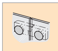
Z vnitřní strany zapuštěné panty
