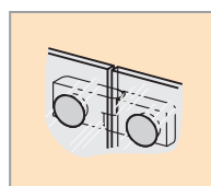
Z vnitřní strany zapuštěné panty
