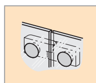
Z vnitřní strany zapuštěné panty
