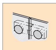
Z vnitřní strany zapuštěné panty
