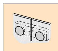
Z vnitřní strany zapuštěné panty
