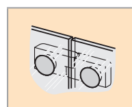
Z vnitřní strany zapažené panty
