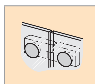
Z vnitřní strany zapuštěné panty
