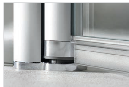
Výkonný zvedací/spouštěcí mechanismus zvedá dveře při otevírání o 5 mm a zamezuje tak smýkání těsnících profilů na podlaze
