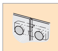
Z vnitřní strany zapuštěné panty
