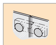
Z vnitřní strany zapuštěné panty
