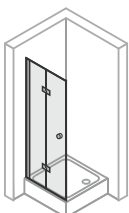
SFT = Křídlové sklapovací dveře
