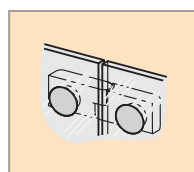
Z vnitřní strany zapuštěné panty
