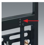
Možnost montáže bidetu ve třech různých výškách, rozteč šroubů pro bidet 18 nebo 23 cm
