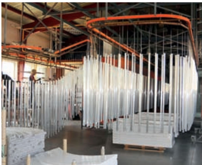
Elektrostatické nanášení práškové barvy na hliníkové profily sprchových koutů, dveří a vanových zástěn.
