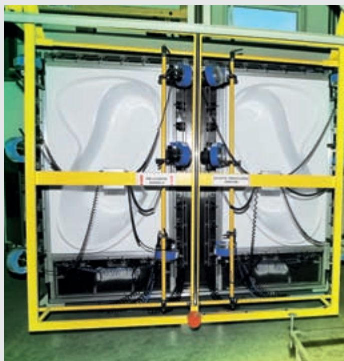
Vyztužení laminátem nebo polyuretanovou pěnou PU
