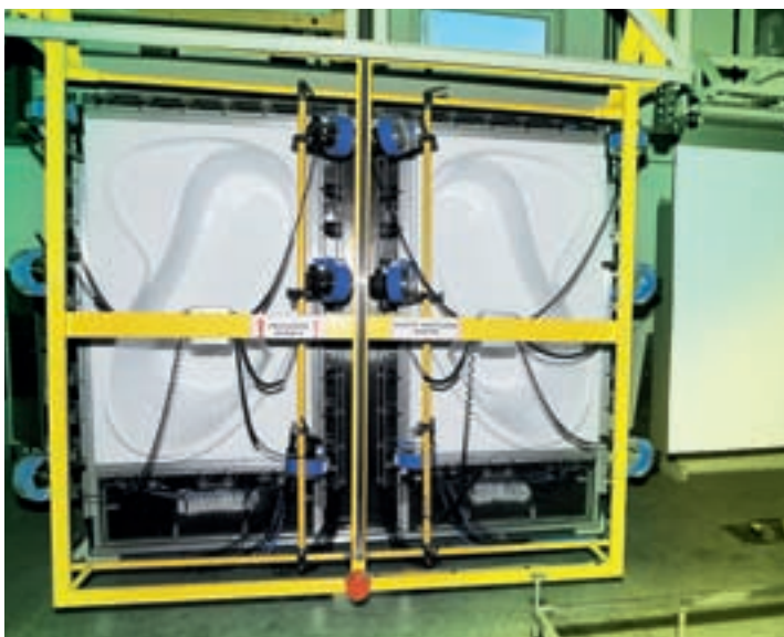
Lisování akrylátového výlisku budoucí vany pomocí nejnovější technologie využívající svíslého ohřevu.
