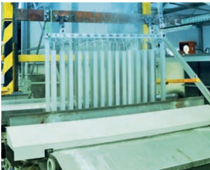
Eloxování hliníkových profilů - výroba nejtvrďší povrchové úpravy satín u sprchových koutů, dveří a vanových zástěn.
